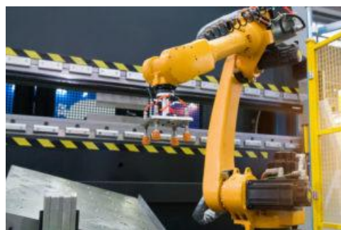
In toepassingen die nauwkeurige bewegingsregeling vereisen, zijn servoregelaars aanzienlijk beter dan frequentieregelaars.
